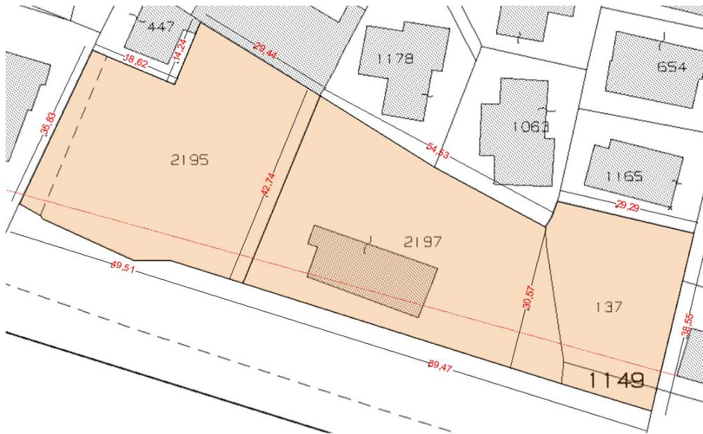
Sul lato opposto a via Pittarini, a est, il confine di proprietà non appare coincidente con la dividenda generata tra i mappali 137 e 753 a danno della proprietà per una superficie di circa 100 mq (in giallo), salvo più precise misurazioni.
